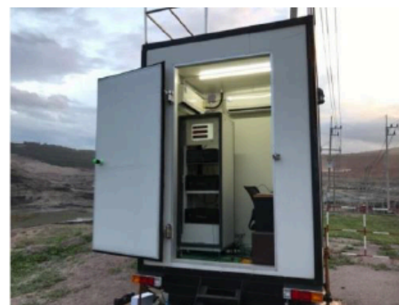
สถานีวัดฝุ่น PM 1.0, PM 2.5 และ PM 10 แบบเคลื่อนที่ในบ่อเหมืองแม่เมาะ จ.ลำปาง
